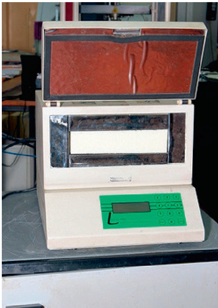
Оборудование для проведения исследований и тестирования. Прибор для определения коэффициента теплопроводности ППУ
