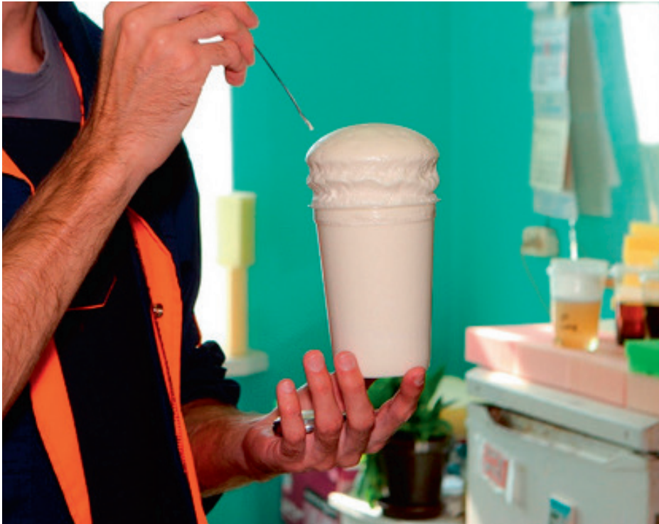
Проведение теста технической пробы. Определение времени гелеобразования
