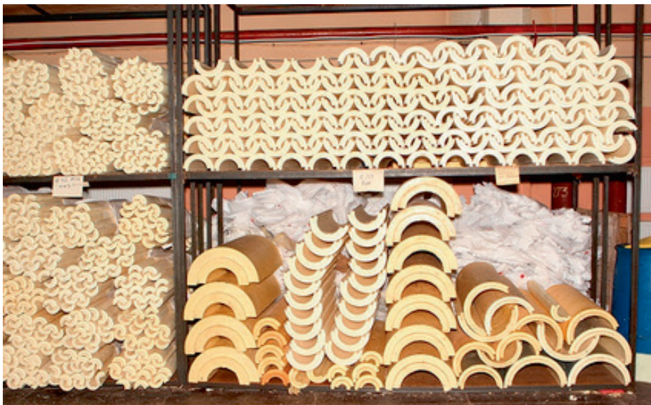
Изготовление скорлуп для теплоизоляции труб. Промежуточное хранение на стеллажах на площадке
