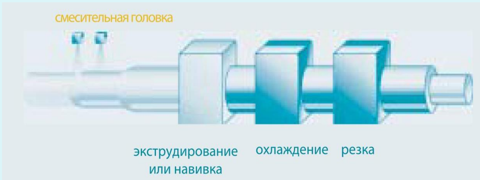
Рисунок 4 - Непрерывное формование методом напыления.
